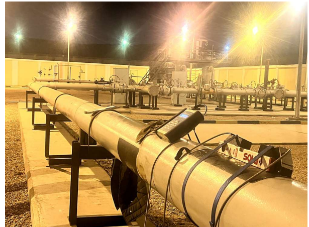
قياس تصرف الغاز بجهاز ألتراسونيك لاصق على الخط Gas flow measurement using a clamp-on ultrasonic device
